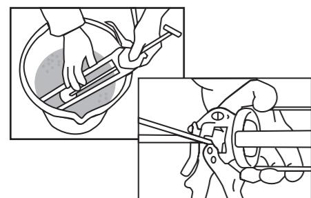
Was het pistool altijd direct na gebruik met water en zorg ervoor dat er geen mortel in het mechanisme achterblijft.
