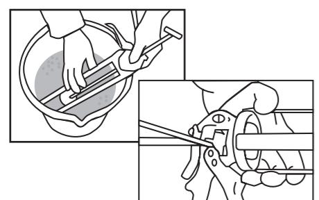
Lavez toujours le pistolet à l'eau immédiatement après utilisation et assurez-vous qu'il ne reste pas de mortier dans le mécanisme.
