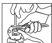
Poussez la plaque de dégagement à l'arrière du pistolet et tirez la poignée en T jusqu'à ce que le piston sorte du conteneur et retirez le conteneur. Si le piston colle parce qu'il est sec, versez de l'eau dans le conteneur de mortier. Confirmez la buse choisie: grise pour les joints de carrelage ; noir pour mortiers, gros joints et joints. Le mortier est trop grossier pour s'écouler à travers la buse grise à moins qu'il ne soit raccourci avec un couteau pour élargir l'ouverture.
