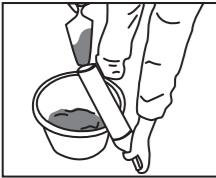
Reinig het mechanisme regelmatig met water om te vermijden dat mortelresten op het systeem achterblijven.
