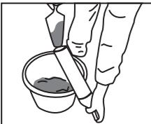
Nettoyez régulièrement le mécanisme avec de l'eau pour éviter que des résidus de mortier ne restent sur le système.
