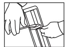
Remarque : Si le piston est difficile à déplacer, même lorsqu'il est mouillé, il est peut-être trop serré. Un petit desserrage des écrous résout ce problème.
